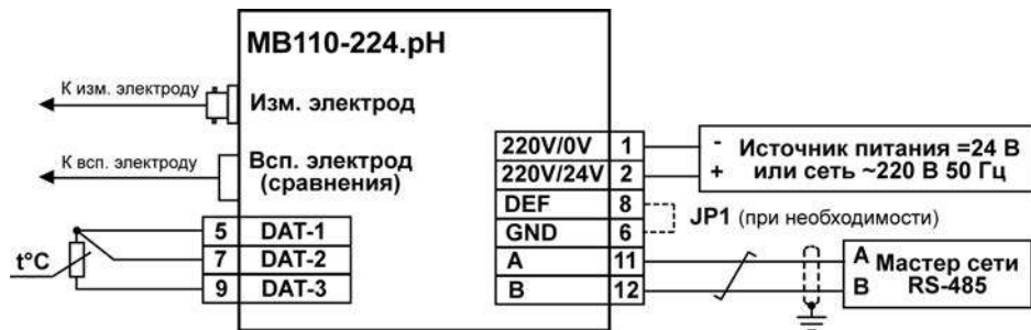
Рисунок 6.1– Подключение к прибору внешних устройств с применением трёхпроводной схемы подключения к датчику температуры и использованием измерительного и вспомогательного электродов
